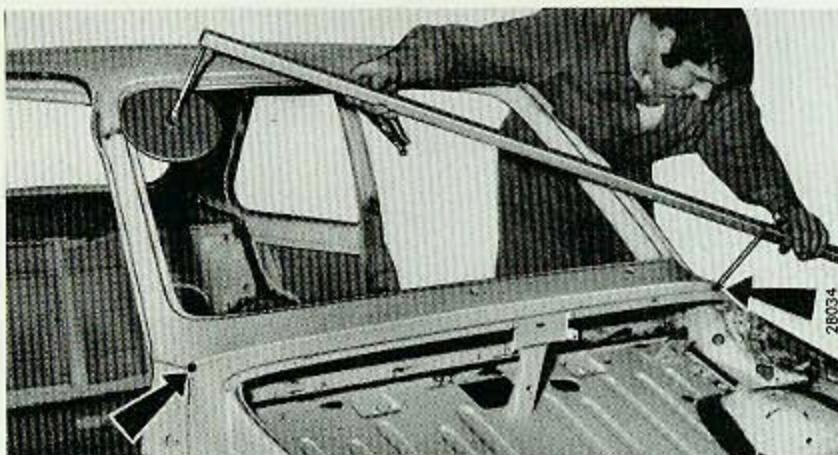
**Verificare il giusto e definitivo posizionamento del ricambio verificando l'uguaglianza delle diagonali (parte posteriore).**
