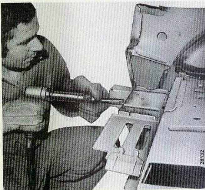
**Fresare i punti di saldatura della parte superiore del rivestimento parafango ancora saldata al fianchetto interno.**
