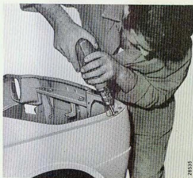
**Svincolare superiormente il rivestimento anteriore dal rivestimento parafango, fresando i punti di unione mediante l'apposito utensile e trapano portatile.**
